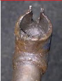
**Pas souvent mis en cause, mais l'usure peut provoquer un jeu d'avant en arrière.**
